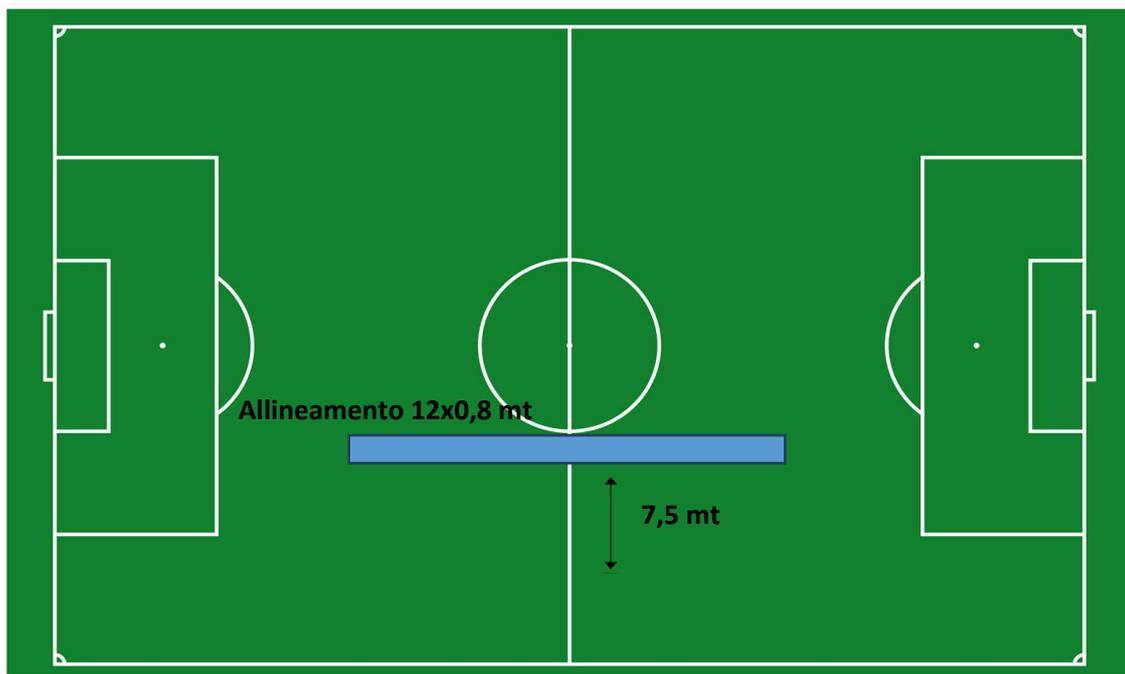
Il pannello di allineamento dovrà essere posizionato alla **distanza di 7,5 metri dalla linea laterale** e la sua metà dovrà corrispondere esattamente con la linea di centrocampo.
